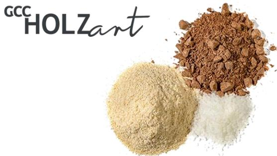
Nuestro material de madera aglomerado con polímeros se compone de hasta un 75 % de fibras de madera. Estos son triturados y mezclados en estado seco con polímeros (plástico reciclado) y aditivos (aglutinante y pintura). Los polímeros utilizados sirven como "adhesivo" y mantienen unidas las fibras naturales.
